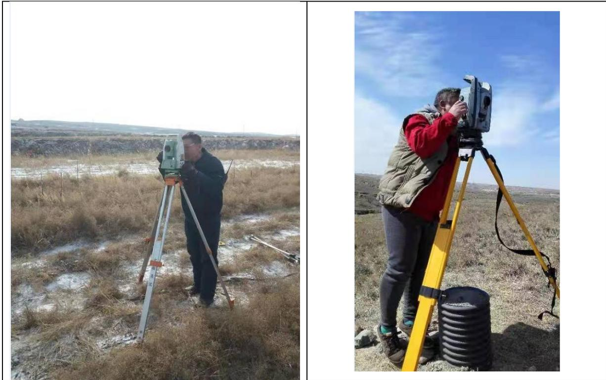
图 5.3-1 岩移观测现场照片
